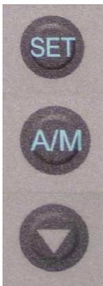
SET 鍵允許改變切換參數到另一個。按住 5 秒進入 Level 1 等級 (PID 參數 + 鎖定功能)。同時按住向左箭頭及 SET 鍵可進入 Level 2 (輸入類型、警報、設定值上下限、數值校正及通訊參數等 ...)。
